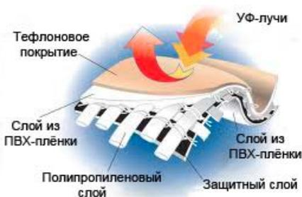
Рис. 1 – Схема ПВХ-ткани [2]
