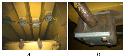
**Рис. 2 - Клавишный механизм соломотряса**
