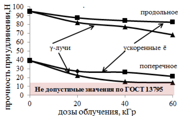
Рис. 2 – Зависимость прочности при удлинении двухслойного ламинированного НМ от поглощенной дозы при радиационной стерилизации ускоренными электронами и гамма-излучением
