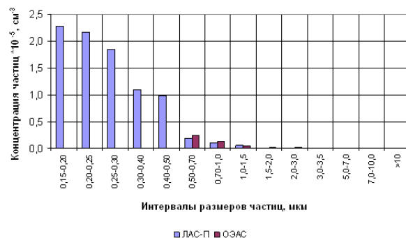
Рис. 4 – Распределение частиц по размерам в аэрозоле состава ВФ-2
