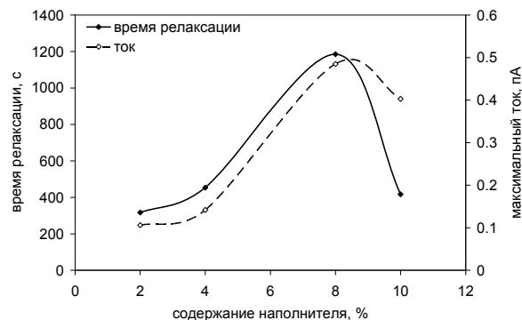
Рис. 4 – Зависимость времени релаксации при температуре 70°C и максимумов токов деполяризации от содержания талька в полиэтилене
