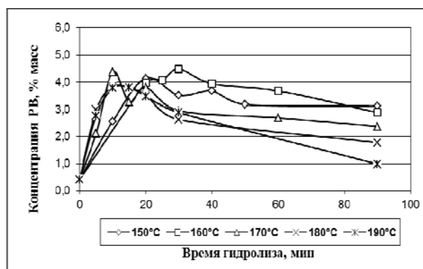
Рис. 1 - Изменение концентрации РВ при варьировании температуры и при концентрации сернистой кислоты 1% масс.
