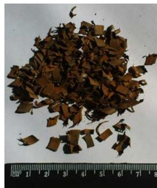
Рис. 1 – Стружка из углеродистой стали
