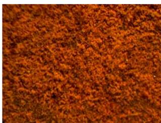
**Рис. 3 – Поверхность стружки из углеродистой стали (приближение 7X) после обработки**
