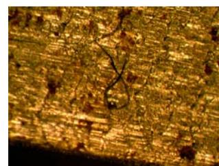
**Рис. 2 – Поверхность стружки из углеродистой стали (приближение 7X) до обработки**
