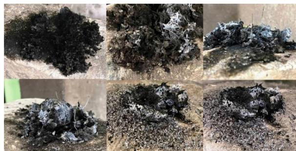
**Рис. 3 – Фотографии продуктов сгорания системы кремний-фторхлорполимер при содержании горючего менее 50 % масс. (общий вид)**
