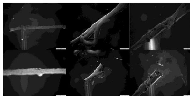
**Рис. 4 – Микрофотографии продуктов сгорания системы кремний-фторхлорполимер при содержании горючего менее 50 % масс. (увеличение 200x)**
