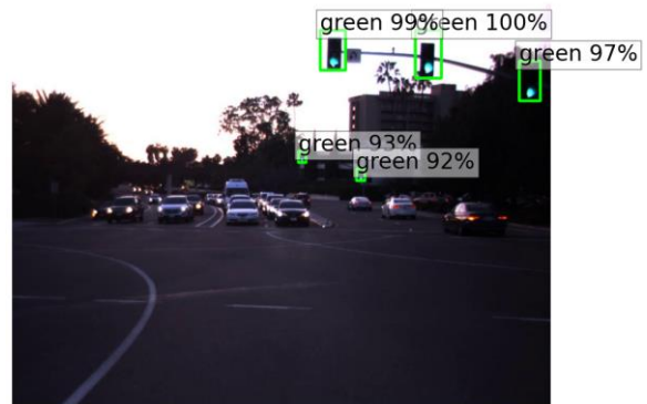
Рис. 3 – Пример распознавания сигналов светофора моделью Faster R-CNN
