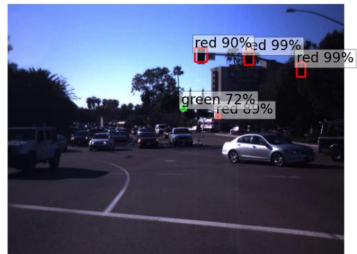
Рис. 4 – Пример распознавания сигналов светофора моделью YOLOv8n
