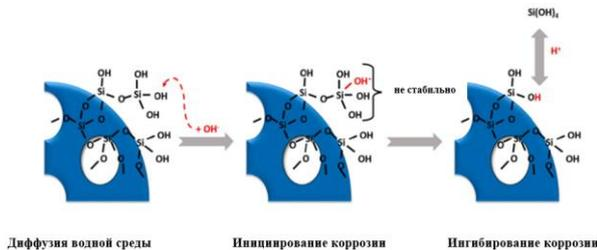
Рис. 2 – Механизм деструкции кремнеземных веществ
