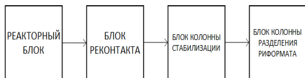
Рис. 1 – Принципиальная схема блоков установки каталитического риформинга
