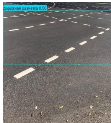
Рис. 3 – Распознавание дорожной разметки на основе предложенной модели
