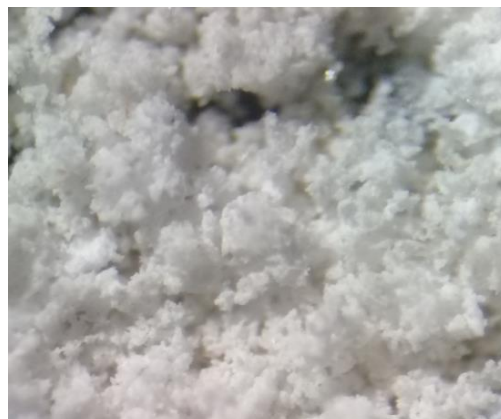
Рис. 2 – Фотоизображение частиц фосфорсодержащего удобрения на основе апатитового концентрата (увеличение в 80х)
