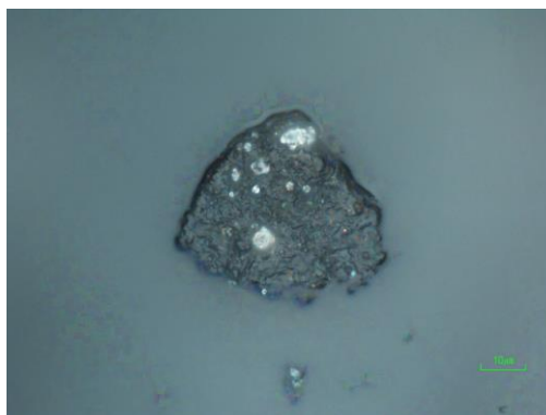
Рис. 3 – Микрофотография частицы фосфоритной муки (увеличение 1000х)
