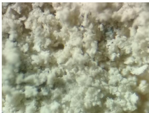
Рис. 4 – Фотоизображение частиц фосфорсодержащего удобрения на основе фосфоритной муки (увеличение 80 х )
