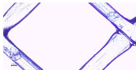
Рис. 3 – Фотография фрагмента сетки из полипропилена
