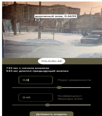
Рис. 4 – Пример распознавания после внедрения метода интеграции слоев
