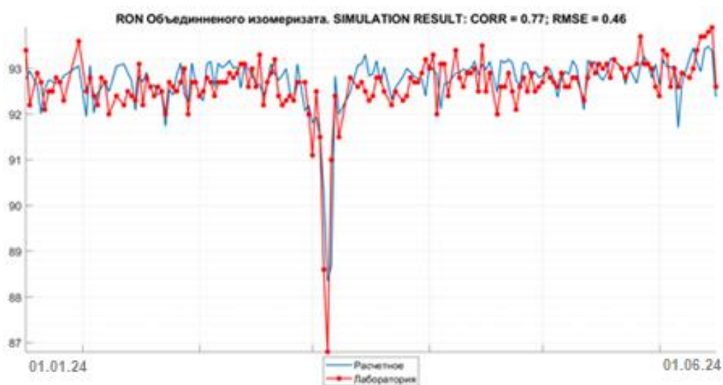
Рис. 3 – ИОЧ изомеризата , полученный лабораторным методом и расчетные значения ИОЧ (сумма аддитивной и неаддитивной составляющих)
