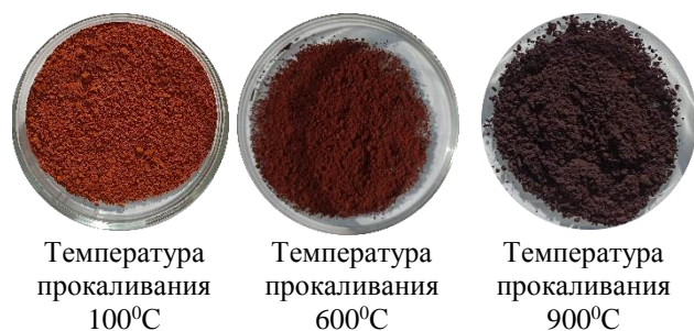
Рис. 4 – Внешний вид прокаленного остатка после выщелачивания при различных температурах
