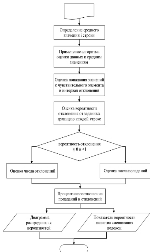
Рис. 1 – Алгоритм оценки равномерности распределения разнородных волокон в поперечном сечении ленты
