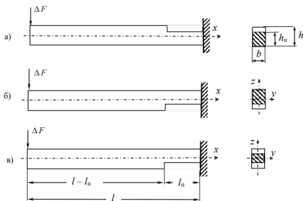
Рис. 1 – Схемы поврежденных балок; разрушение в верхней части сечения (а); разрушение в нижней части сечения (б); разрушение с двух сторон (в)
