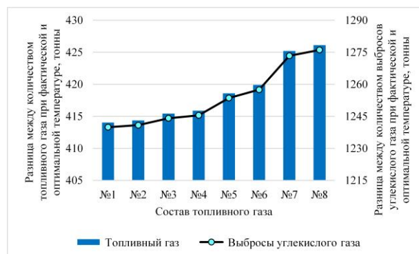
Рис. 4 – Разница между количеством топливного газа, сжигаемого в печи, и разница между количеством выбросов углекислого газа при фактической и оптимальной температуре
