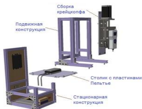
Рис. 3 – Четыре основные структуры системы измерения сцепления со льдом при растяжении [20]
