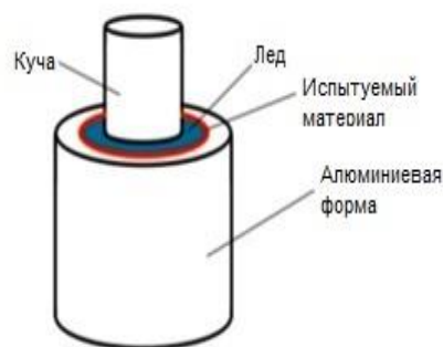
Рис. 4 – Диаграмма испытания конуса 0^{\circ} для определения прочности сцепления на льду [48]
