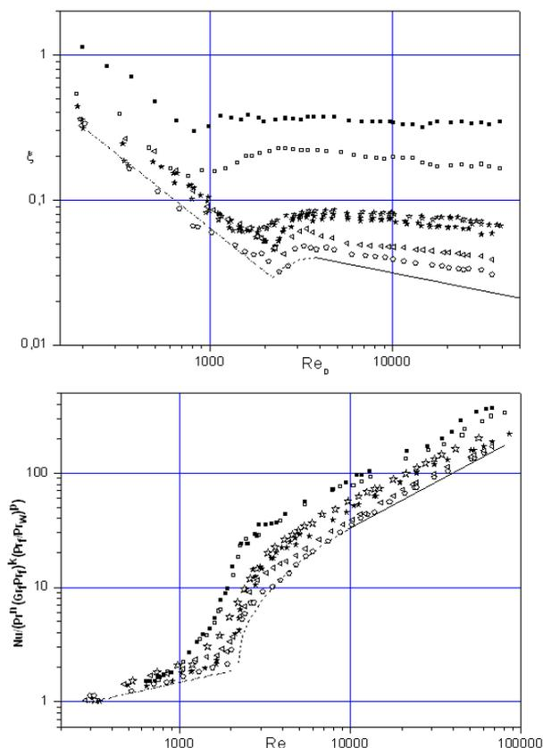
Рис. 3 - Экспериментальные данные по гидросопротивлению и по средним коэффициентам теплоотдачи в каналах с трехмерной шероховатостью. Обозначение в табл.2. Линии – расчет по (1) и (2)
