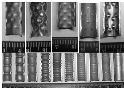
Рис. 1 - Фотографии профилей сечения труб с полусферическими выступами (3D-шероховатость) и с кольцевой накаткой (2D-шероховатость)
