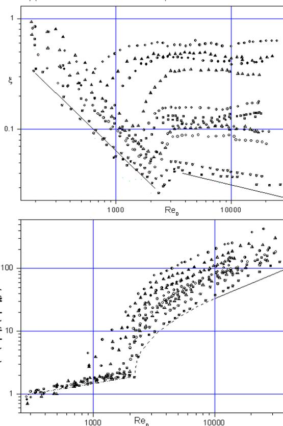
Рис. 2 - Экспериментальные данные по гидросопротивлению и теплоотдаче в каналах с кольцевой накаткой. Обозначение в табл.1. Линии – расчет по (1,2) и (3)
