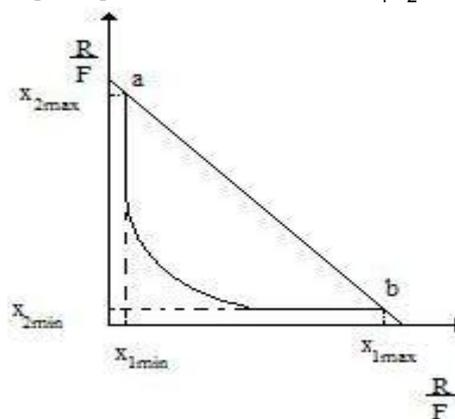
Рис. 2 - Вид семейства стационарных состояний (кривая ab) на выходе реактора на плоскости  $X_1 X_2$
