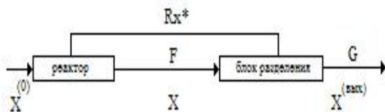
**Рис. 1 - Блок-схема рециркуляционной системы реактор-блок разделения**
