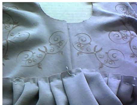
Рис. 3 - Пример лазерной гравировки синтетического трикотажа
