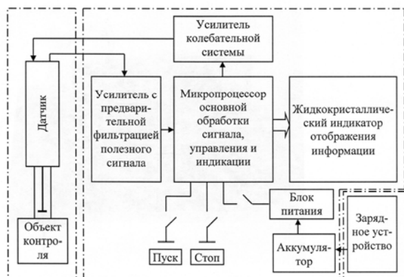
Рис. 3 — Функциональная схема прибора «Поверхность-11»
