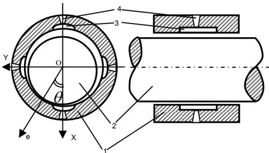
Рис. 1 – Схема ГСПУ: 1 – втулка подшипника, 2 – вал подшипника, 3 – гидростатические камеры, 4 – дросселирующие элементы
