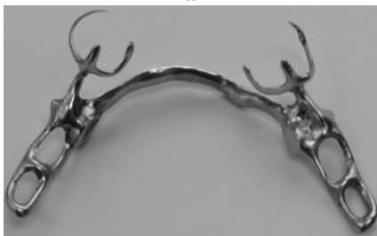
Рис. 1 - Образцы стоматологических зубных мостов из стали марки 25Х18Н9С2 обработанные многоканальным разрядом при атмосферном давлении: a – до обработки, б – после обработки
