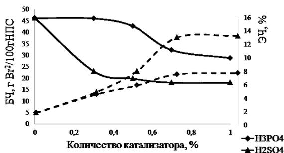
**Рис. 3 – Зависимость бромного и эпексидного чисел от концентрации и вида катализатора (— - бромное число, --- - эпексидное число)**
