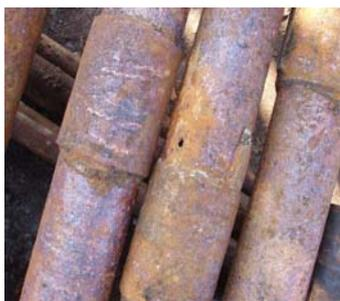
**Рис. 1 – Сквозная наружная коррозия эксплуатационной колонны**
