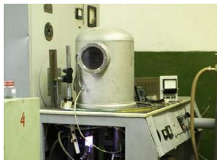
**Рис. 6 -** Вакуумный блок установки для получения ВЧ плазмы
