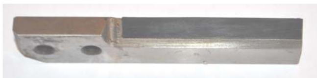
Рис. 1 - Рабочий нож установки грануляции полиэтилена
