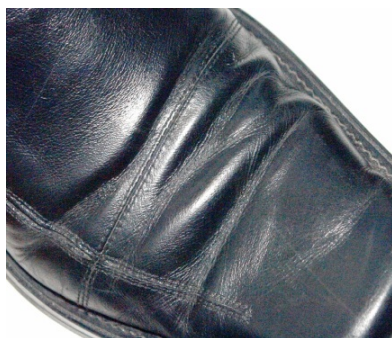
Рис. 15 - Вид обуви сбоку после опытной носки: а) без плазменной обработки; б) с плазменной обработкой.
