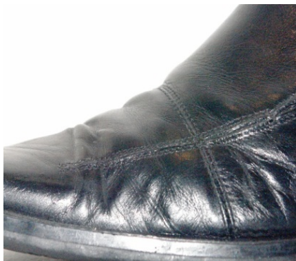
Рис. 15 - Вид обуви сбоку после опытной носки: а) без плазменной обработки; б) с плазменной обработкой.
