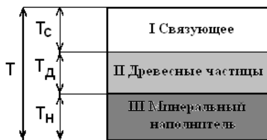
Рис. 1 - Распределение компонентов в композиционном материале ПЛИТОТРЕН
