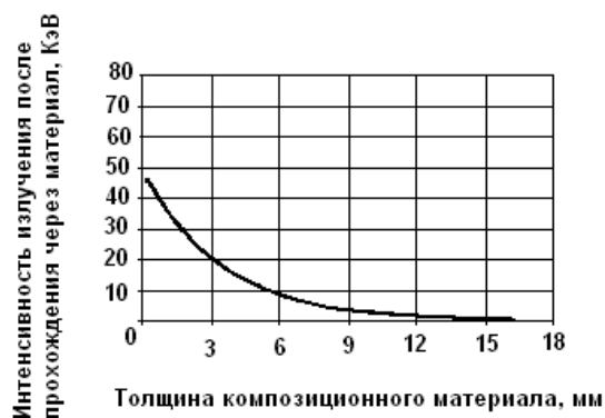
Рис. 3 - Зависимость интенсивности излучения от толщины композиционного материала ПЛИТОТРЕН
