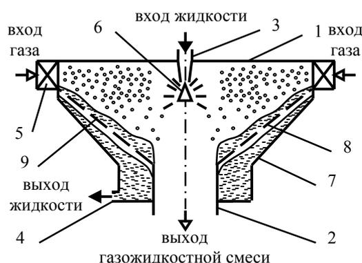
**Рис. 1 – Теплообменное устройство для контакта газа и жидкости в вихревом потоке: 1 – корпус, 2 – патрубок для выхода газожидкостной смеси на сепарацию, 3 – патрубок для входа жидкости, 4 – патрубок для выхода жидкости, 5 – тангенциально-лопаточный завихритель, 6 – форсунка, 7 – коническое днище без перфорации, 8 – коническое днище с перфорацией, 9 – отверстия для отвода стекающей по внутренней поверхности корпуса жидкости**
