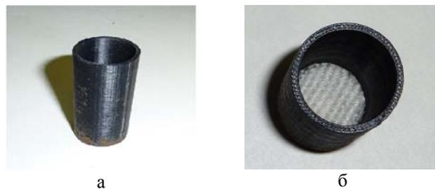
Рис. 2 – Фильтрующие стаканчики лабораторной центрифуги: а - вид сбоку; б - вид сверху
