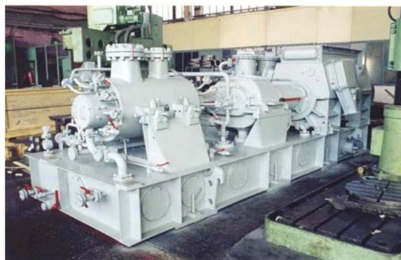
**Рис. 1 - Компрессорная установка 2ГЦ2-23/21-37 УХЛ4**
