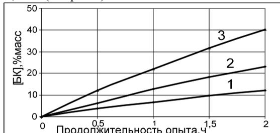
**Рис. 1 - Влияние температуры на накопления бензойной кислоты при окислении АЦФ (см. табл.1) при подаче воздуха 200 л/л\*час, дозировке катализатора бензоата Mn - 0,1% масс. Температура опыта, °C: 1 – 110, 2 -130, 3 – 150**
