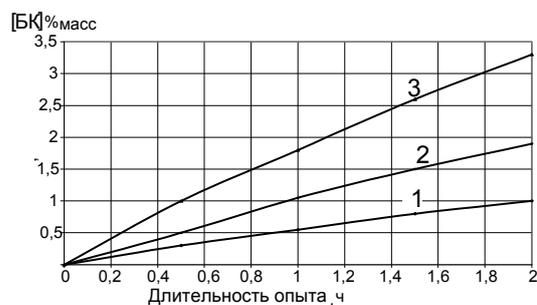
**Рис. 2 - Влияние температуры на накопления бензойной кислоты при окислении АЦФФ\* (см. табл.1), содержащей 30 % масс АЦФ, при подаче воздуха 200 л/л\*час, дозировке катализатора бензоата Mn - 0,1% масс. Температура опыта, °C: 1 – 110, 2 -120, 3 – 130**
