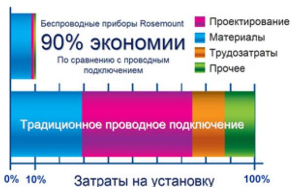
Рис. 1 - Затраты на внедрение системы Smart Wireless в сравнении с традиционным проводным подключением
