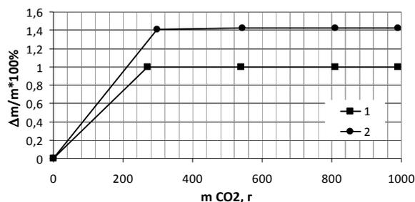
Рис. 3 Изменения массы катализатора в процессе его регенерации в зависимости от массы, участвовавшего в процессе экстрагента (модифицированный  $\text{CO}_2$ ): 1 – сверхкритический  $\text{CO}_2$ ; 2 – сверхкритический  $\text{CO}_2$  + 7% ДМСО
