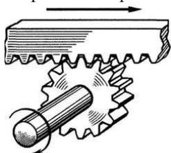
Рис. 1 – Зубчато-реечный механизм.
