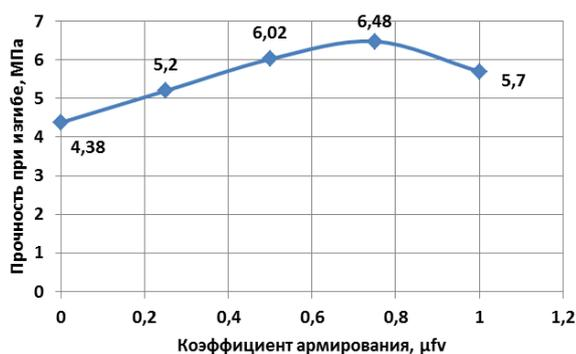
**Рис. 3 - Зависимость изменения предела прочности при изгибе образцов сталефибробетона при увеличении коэффициента объемного армирования**
