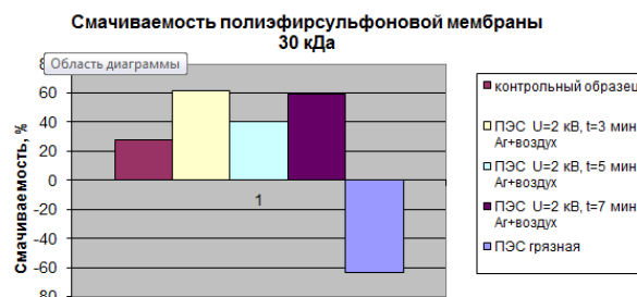
Рис. 2 – Смачиваемость полиэфирсульфоновой мембраны 30 кДа
