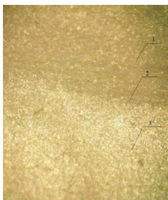
Рис. 2 - Зона термического влияния при плазменной закалке(×200раз): 1 зона цементита; 2 граница упрочненного слоя; 3 сердцевина с ферритно-перлитной структурой
