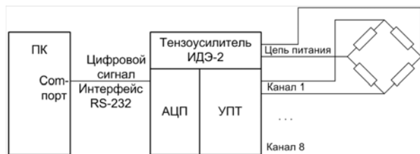
Рис. 2 - Электрическая схема подключения сопротивлений к генератору
