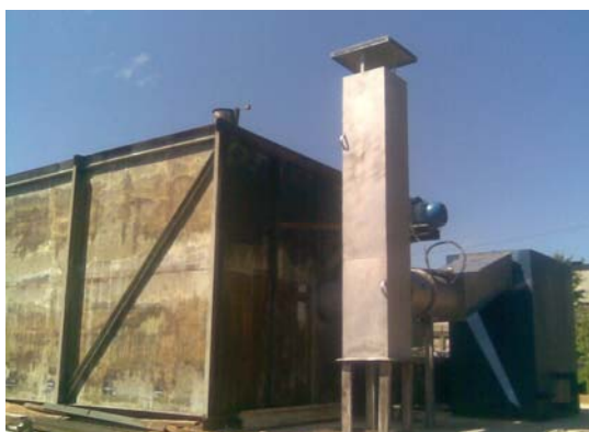
Рис. 2 – Внешний вид промышленной установки по термическому модифицированию древесины в среде топочных газов
