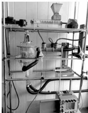
Рис. 3 - Экспериментальная установка «динамический газопромыватель»
