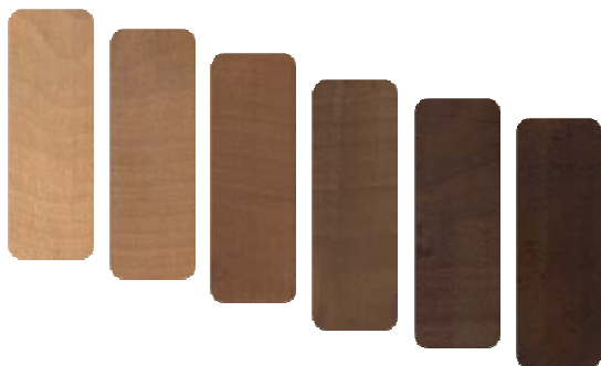
Рис. 1 - Изменение цветовой гаммы образцов древесины березы при температуре обработки 180-240°C в течении 2-8 часов
