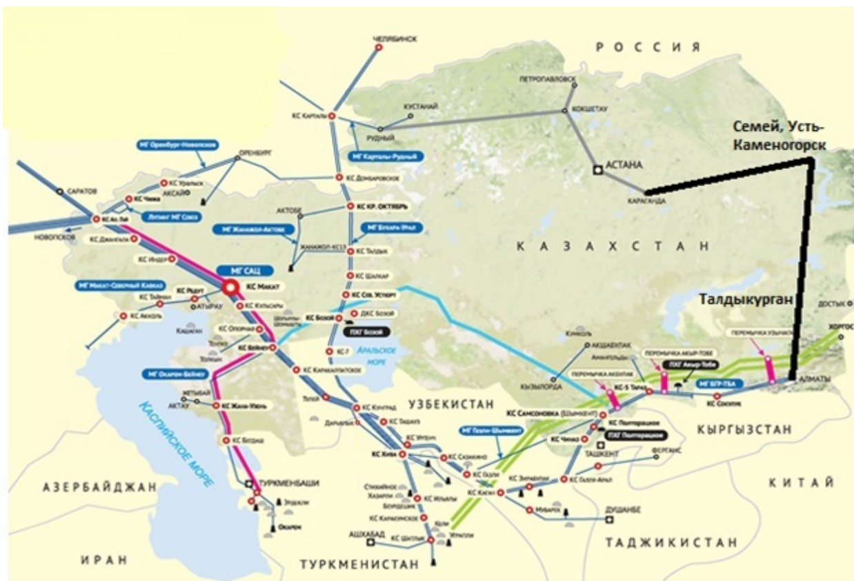
Рис. 1 – Газопровод Центр – Восток - Юг
