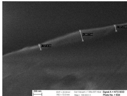
Рис. 2 - СЭМ изображение среза металлизированной ткани в отраженных электронах (ЕНТ = 20.00 кВ, увеличение 100 000х)
