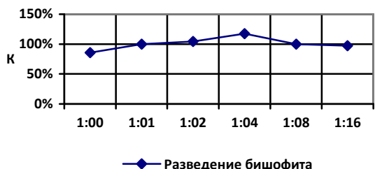
Рис. 1 – Зависимость коэффициента прироста биомассы активного ила от разведения биофита
