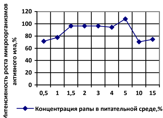
Рис. 3 – Зависимость интенсивности роста микроорганизмов активного ила в % от концентрации рапы в питательной среде
