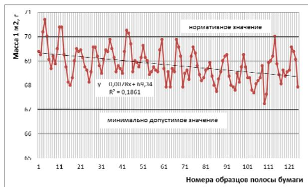
**Рис. 2 – График колебаний массы 1 м² за период наработки исследуемой полосы бумаги**
