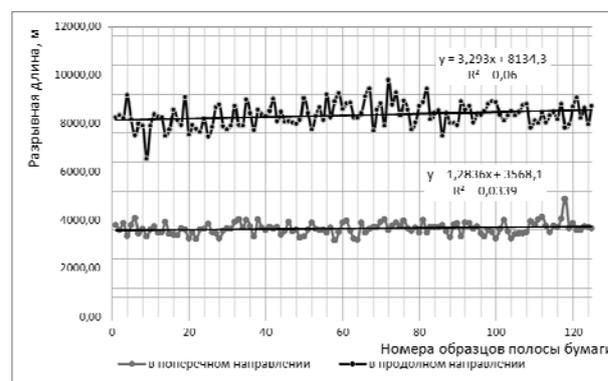
**Рис. 3 – Результаты измерения разрывной длины образцов полосы бумаги**
