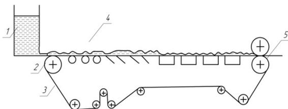
Рис. 1 – Схема к обоснованию образования волнистости бумажного полотна: 1 – напорный ящик; 2 – грудной вал; 3 – сетка; 4 – бумажная масса; 5 – гауч-пресс
